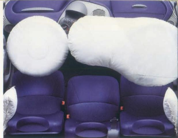
più avanzati di guidabilità e sicurezza dinamica è assicurato dall'impostazione meccanica, trazione anteriore, sospensioni a ruote indipendenti. Particolare attenzione è stata dedicata alla sicurezza degli occupanti protetti oltre che dall'airbag guidatore, anche da un doppio airbag per i passeggeri e dal side bag toracico.
